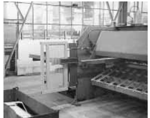
Bild 6: Sicherheitstechnische Massnahmen zur Sicherung der Maschinenrückseite sind Lichtschranken, Schutzgitter, Entfernungsvorrichtungen wie Rutschen oder mobile Sammelstische für die geschnittenen Bleche.
