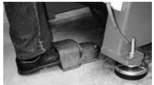
Bild 2: Der Fusschalter muss mit einer Schutzhaube ausgestattet sein.
